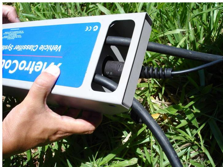
Coletor de dados do equipamento MetroCount
