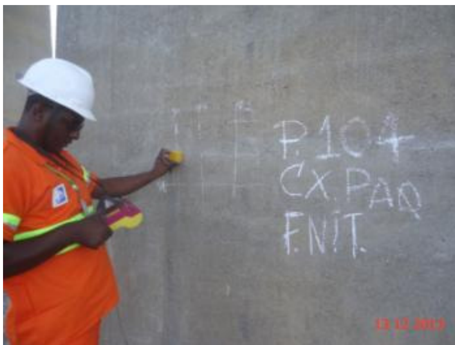
Foto 8 – Verificação do revestimento das armaduras com utilização do Profômetro – Pilar 104 – Sentido Nit./RJ – Trecho sobre o Mar
