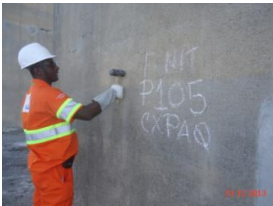
Foto 3 – Execução de ensaio de percussão no concreto – Pilar 105 – Sentido Nit./RJ – Trecho sobre o Mar
