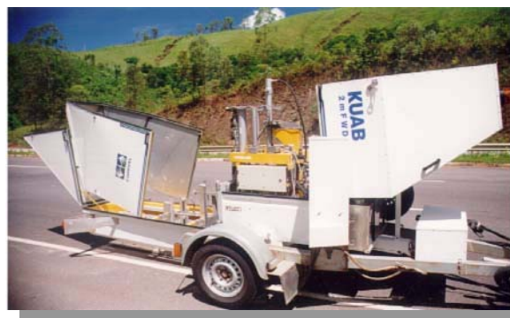
Figura 3.1. Vista de equipamento FWD modelo KUAB.
