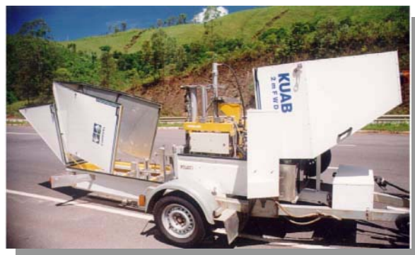
Figura 3.1. Vista de equipamento FWD modelo KUAB.
