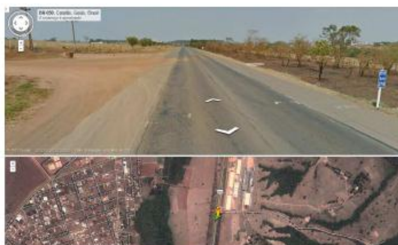
Figura 10: Trecho da BR-050 onde poderá ser alocado a Interseção tipo Diamante para acesso às misturadoras e a Anglo American Fosfato, previsto na alternativa de estudo 4.
